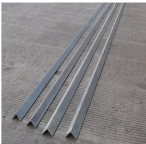
图4 L30 mm × 30 mm × 3 mm的长条角钢
